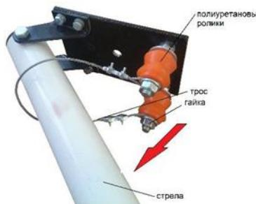
При наезде на стрелу в закрытом положении она выскакивает из полиуретановых роликов и откидывается см. Рисунок 11.
